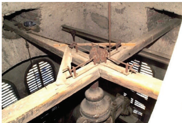
Fig.3. Componente ale mecanismului ruinat, de repartizare a forței la arătătoarele celor patru cadrane din turnul vestic, toate realizate de meșterul lăcătuș Daday József. Azi, despre soarta cadranelor și arătătoarelor nu se știe nimic. În februarie 2011, suprafața pieselor menționate era deja puternic corodată.
