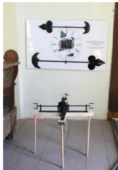
Fig.6. Două limbi de ceas originale (orar și minutar) și subansamblul de distribuție a mișcării la arătătoare, după restaurare (2018).
