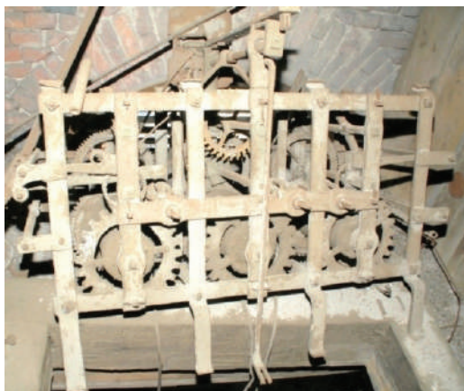
Fig.2. Orologiul-mamă construit de Tébi János. Imaginea prezintă starea acestuia în februarie 2011 – mișcat din locul de serviciu, cu cadrul și subansamblurile componente originare ruginite și patinate, frânghiile tăiate și eliminate de pe tambururi.
