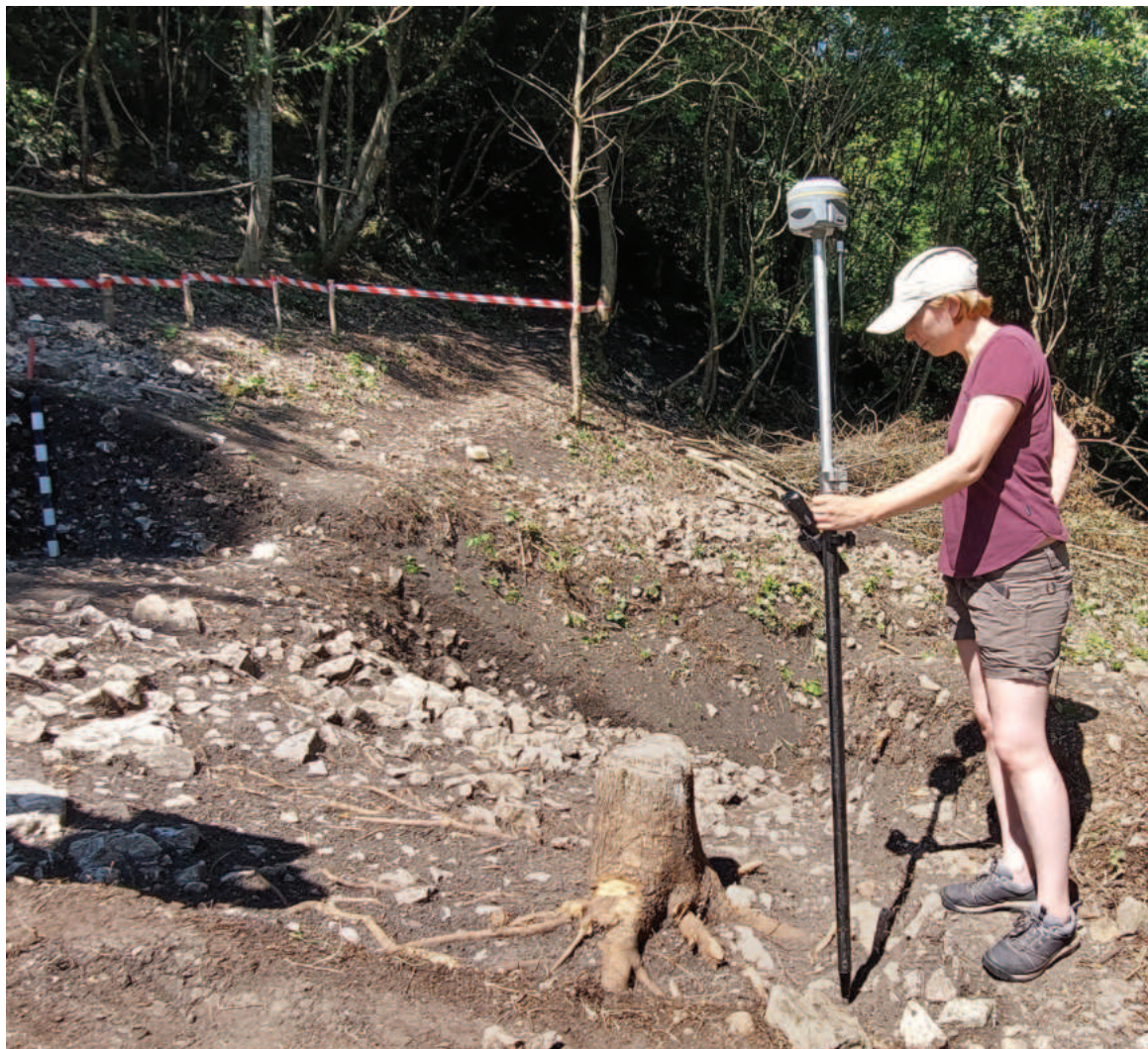
Fig. 15. Înregistrarea datelor topografice prin intermediul unui aparat DGPS, foto V. Palaghie. / Fig. 15. The process of recording geographical coordinates using a GNSS rover. Photo by V. Palaghie.
